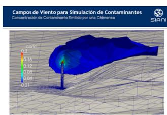
En esta otra figura, se puede ver un detalle de la malla y de los valores de la concentración de un contaminante en el entorno de una chimenea.
